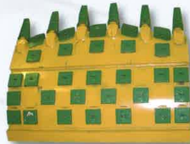
Hochlöffelklappe mit Verschleißschutzplatten und Messerschutzschilden
