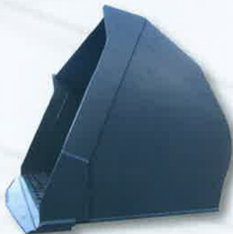
Leichtgutschaufel 6 hier mit Unterschraub-Trapezmesser
