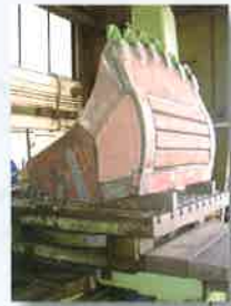
Hochlöffelklappe mit Verschleißschutzplatten und Messerschutzschilden
