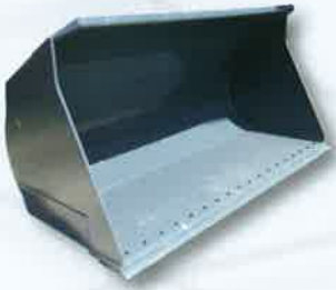
Standardschaufel mit Unterschraubmesser 1
